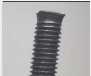
螺栓柱损坏变形
