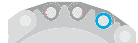
La chaîne de distribution peut s'allonger en raison de l'usure au niveau des boulons et dans les douilles.
