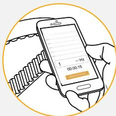
2 Tocca il pulsante "Avvia misurazione". Appare un timer impostato su 15 secondi. Hai tre secondi per posizionare il microfono del tuo smartphone il più vicino possibile alla cinghia.
