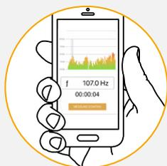
4 Al termine della misurazione verrà emesso un segnale acustico e sul display del telefono verrà visualizzata la frequenza misurata in Hz.
